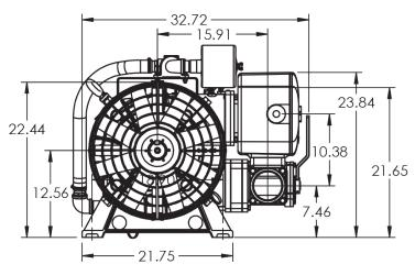
LEFT SIDE PUMP WITH FILTER & PULLEY
