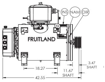
LEFT UPRIGHT PUMP WITH FILTER & PULLEY
